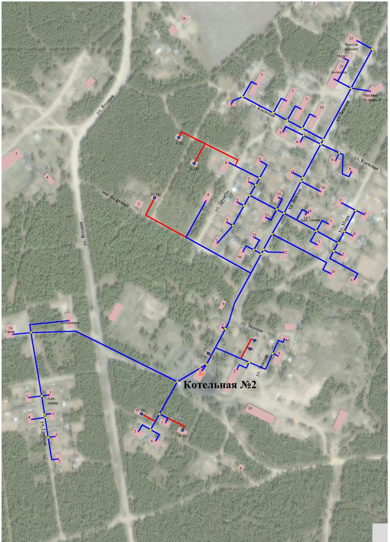
Рисунок 1.3 – Зона действия и схема тепловых сетей котельной №2
