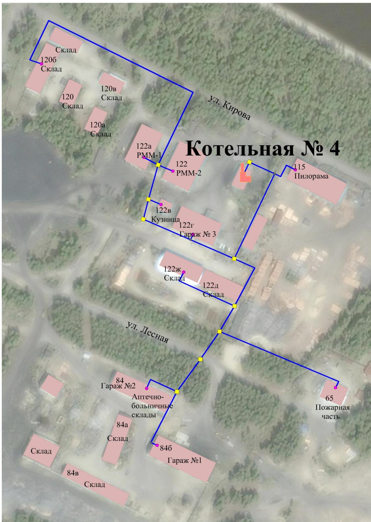
Рисунок 1.5 – Зона действия и схема тепловых сетей котельной №4
