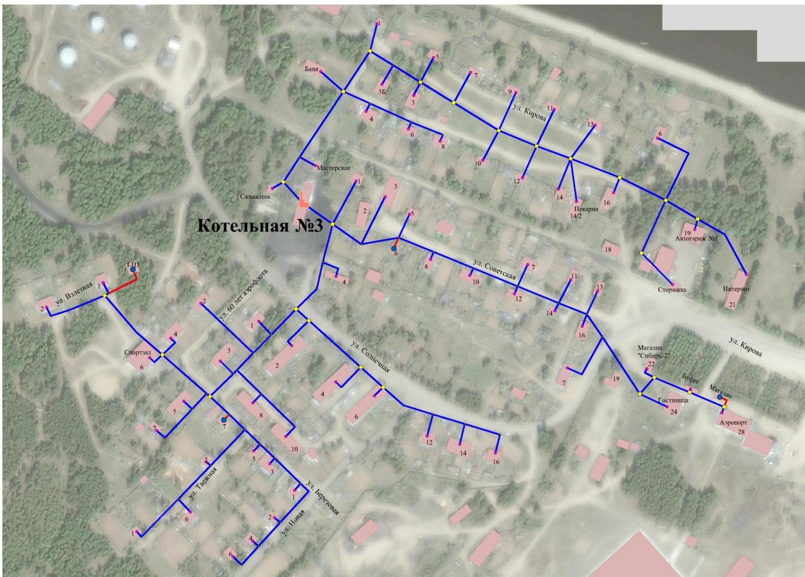
Рисунок 1.4 – Зона действия и схема тепловых сетей котельной №3
