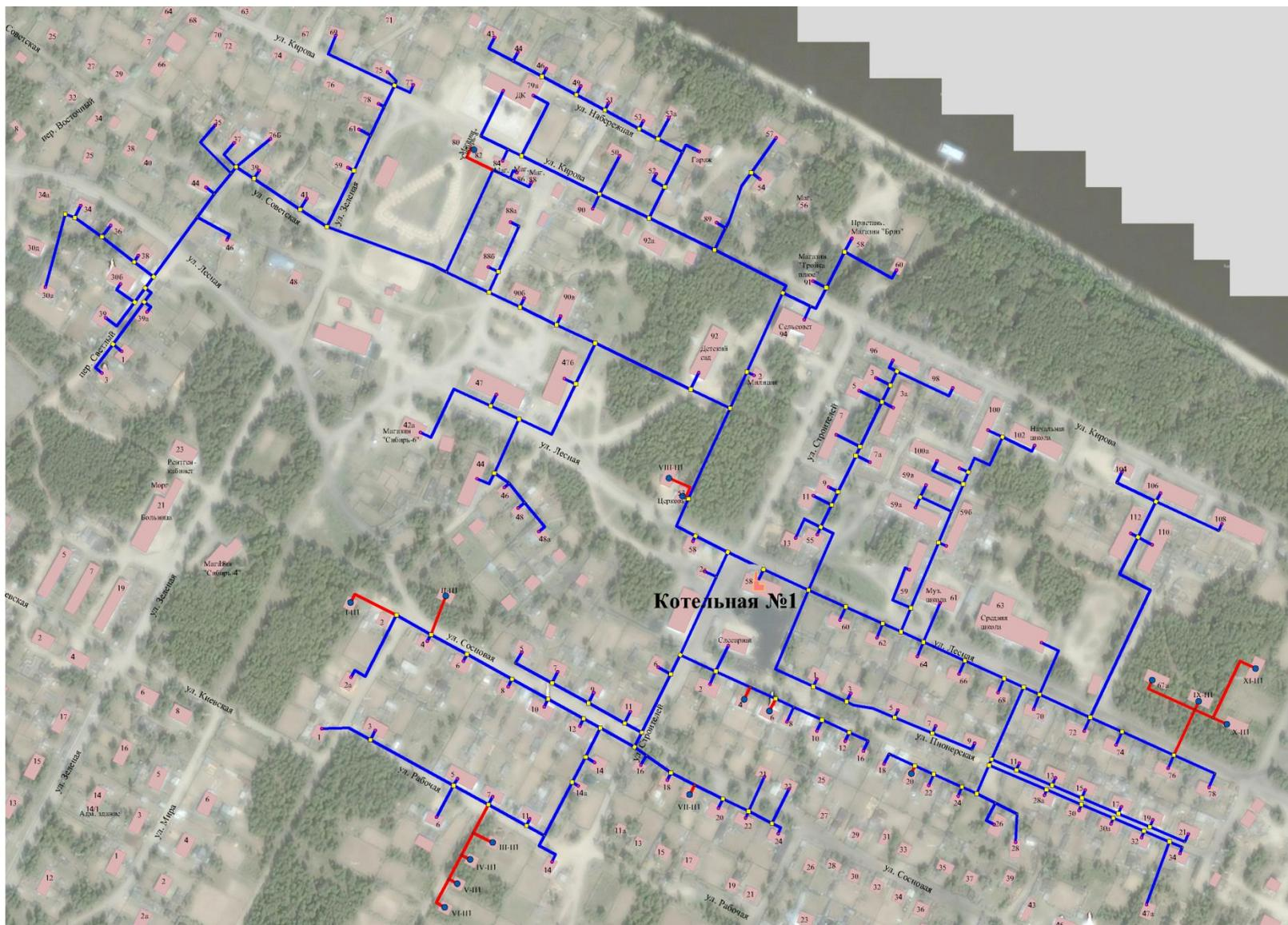
Рисунок 1.2 – Зона действия и схема тепловых сетей котельной №1
