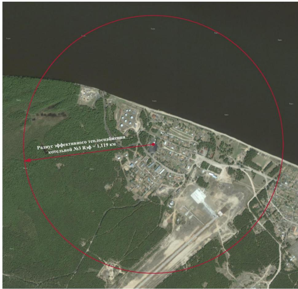
Рисунок 2.3 – Радиус эффективного теплоснабжения котельной №3
