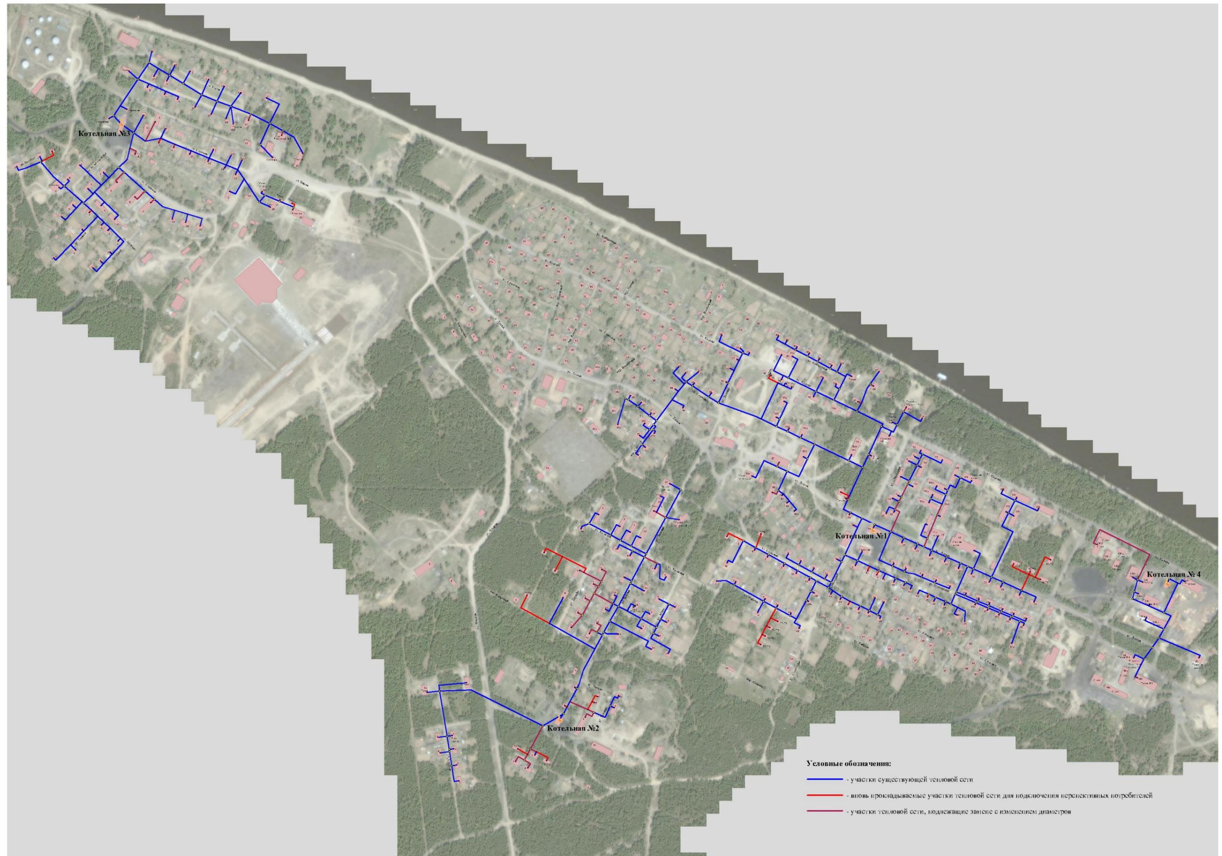
Рисунок 2.5 – Перспективная зона действия и схема тепловых сетей котельных п. Бор
