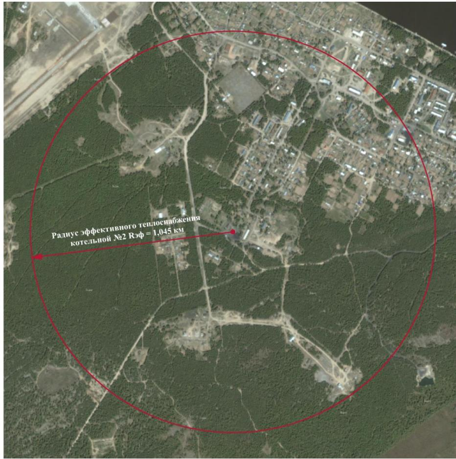
Рисунок 2.2 – Радиус эффективного теплоснабжения котельной №2
